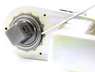
11. Per rimuovere il braccio di reazione, posizionare un cacciavite all'inizio dell'anello d'arresto e aprirlo. Estrarre quindi l'anello d'arresto e rimuovere il braccio di reazione.
