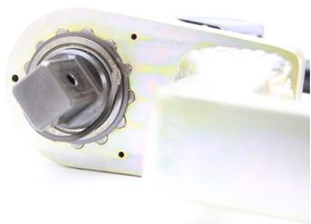
9. Aprire l'anello d'arresto con un cacciavite e posizionare il lato aperto nella scanalatura all'estremità del cambio.
