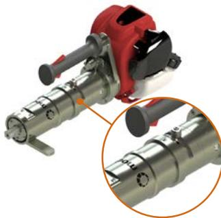
Le **limiteur de couple** pour actionneurs rotatifs portables modtec permet de déconnecter le moteur de la boîte de vitesse lorsque la limite de couple est atteinte. La tête de l'actionneur n'a alors plus de couple résiduel appliqué.
